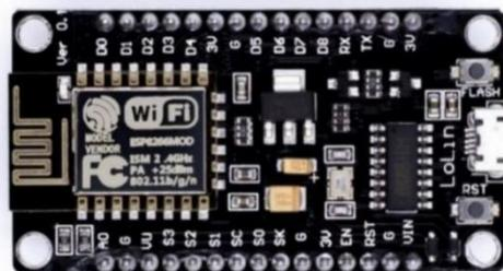
Gambar 2. Mikrokontroler board ESP8266 NodeMCU-12E
