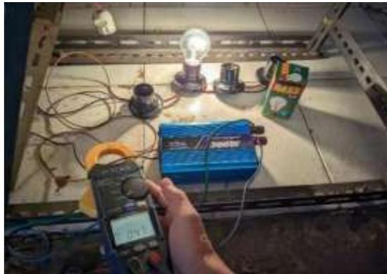
Gambar 6. Pembebanan Pada *Inverter*
