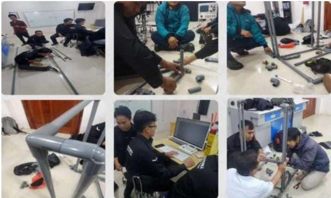
Gambar 17. Proses Perakitan Karakuri *Lifter Rack*
