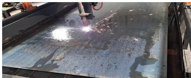
Gambar 2. Proses Pemotongan Plat dengan laser Cutting
